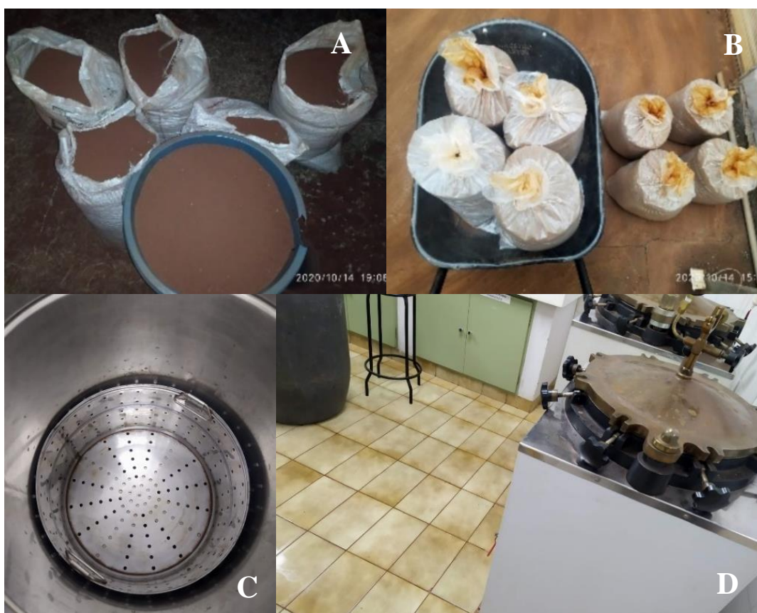
FIGURA 2. Solo peneirado (A); solo acondicionado em sacos plásticos para ser esterilizado (B); autoclave - vista interna (C); vista externa (D). Dourados-MS, UFGD, 2020. Fonte: Da autora.
