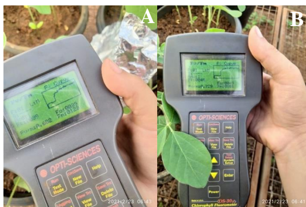
FIGURA 6. Fluorômetro portátil de clorofila (OS-30p; Opti-Sciences Chlorophyll Fluorometer , Hudson, NY, USA) – Papel alumínio envolto por 20 minutos no terceiro trifólio, para posterior avaliação (A); leitura do equipamento dos parâmetros avaliados (B). Dourados-MS, UFGD, 2021. Fonte: Da autora.
